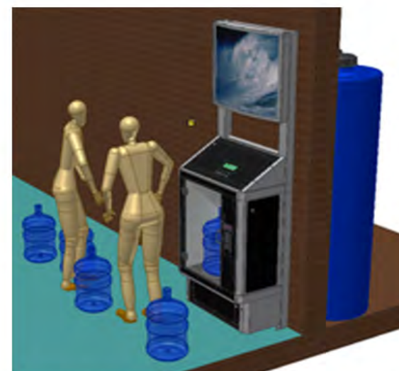
Наливной модуль и система фильтрации находится в другом помещении (за стеной)
